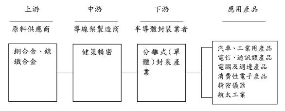
本公司在LED產業供應鏈中所扮演的角色為封裝業導線架供應商。導線架又稱引線架、框架或支架,與金線及封裝膠為封裝業的三大原料。導線架依其構裝領域不同可區分為:積體電路導線架、發光二極體導線架及電晶體導線架等三種。此三種導線架的功能分別在於作為晶片、發光二極體或電晶體與印刷電路板線路連接之媒介。
